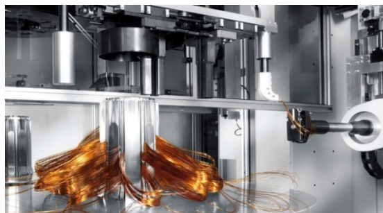
รูปที่ 4-29 กระบวนการพันขดลวดมอเตอร์ (Motor Winding Process)
