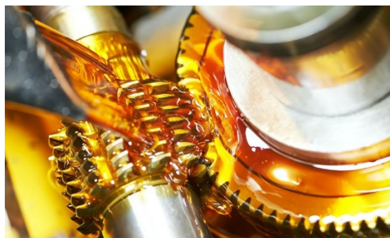
รูปที่ 4-35 กระบวนการกัดเฟืองเกียร์ (Gear Hobbing)
