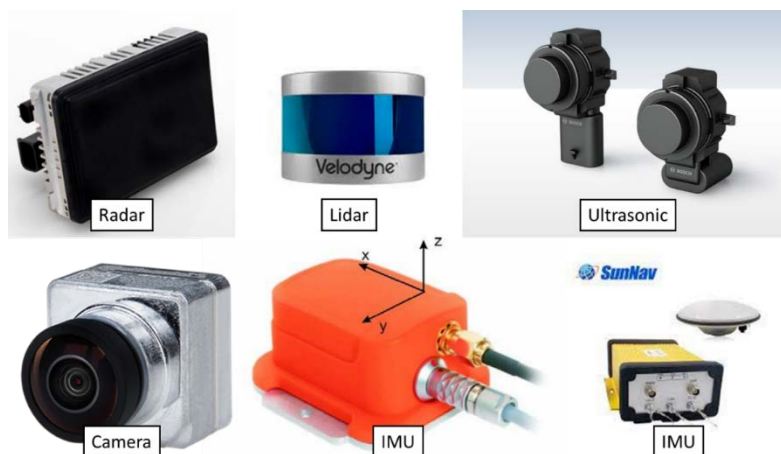
รูปที่ 4-19 เซ็นเซอร์ของระบบช่วยขับขี่ขั้นสูงและระบบขับขี่อัตโนมัติ
