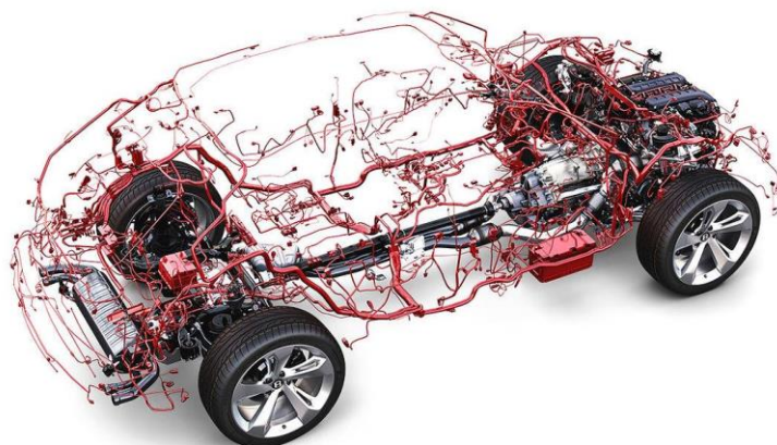
รูปที่ 3-1 รูปแบบการติดตั้งสายไฟแบบเก่า
