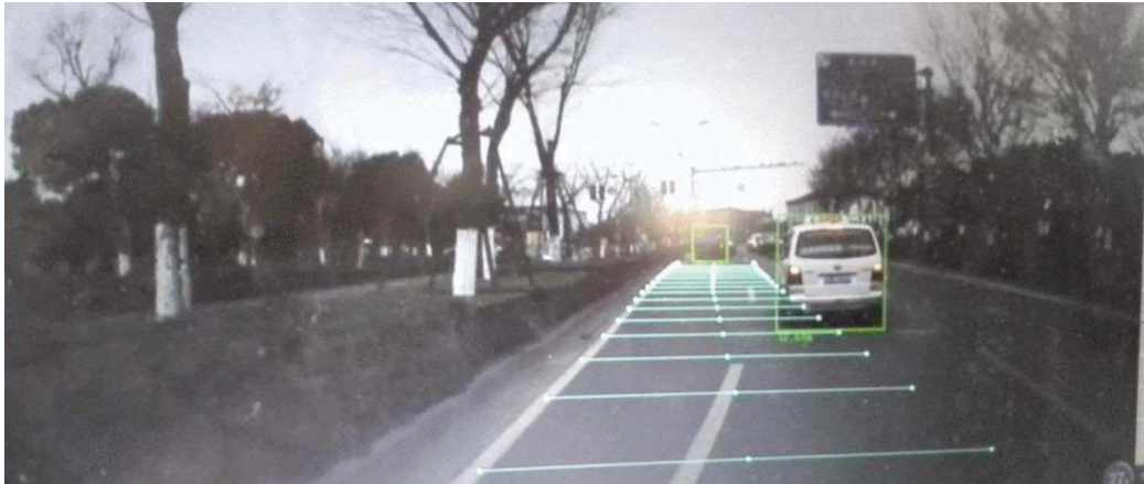
รูปที่ 4-2 การรวมข้อมูลเซนเซอร์ (Sensor Fusion) [ที่มา: Advanced Driver Assistance Systems, Semantic Scholar]
