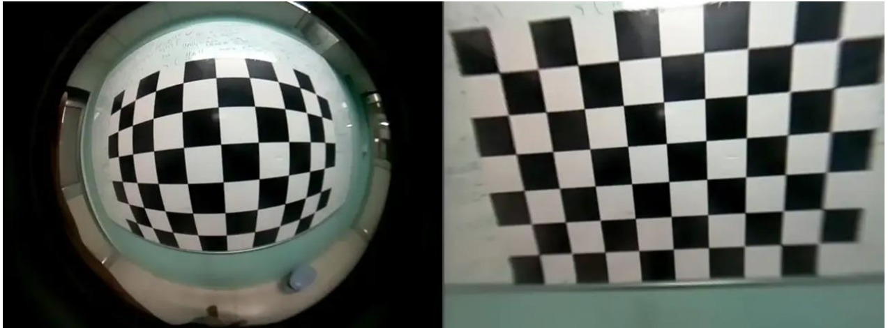
รูปที่ 2-4 การบิดเบี้ยวของภาพจากเลนส์ (รูปซ้าย) และการแก้การบิดเบี้ยวจากเลนส์ (รูปขวา) [ ที่มา: LearnOpenCV ]
