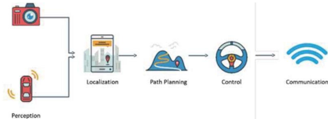
รูปที่ 1-2 ส่วนประกอบของระบบขับเคลื่อนอัตโนมัติ
