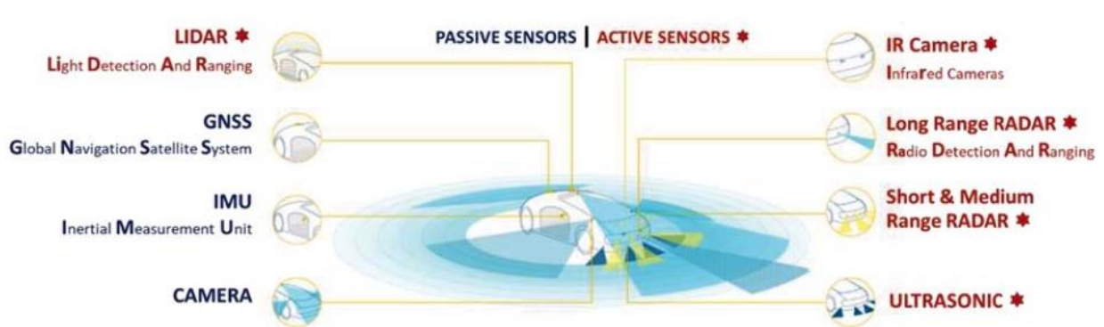
รูปที่ 2-1 เซนเซอร์ในยานยนต์อัตโนมัติ
