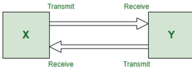
รูปที่ 19 Point to point Topology ที่มา: https://www.geeksforgeeks.org/difference-between-point-to-point-link-and-star-topology-network/
