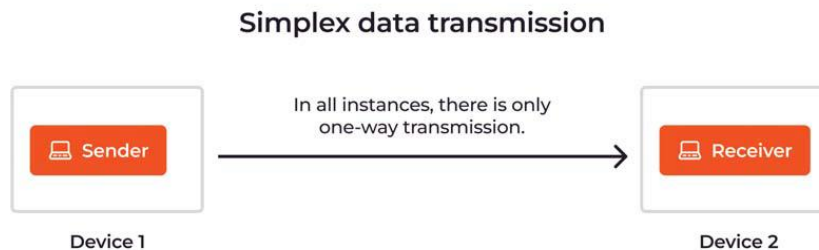
รูปที่ 10 การส่งข้อมูลแบบ Simplex
