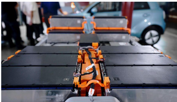
รูปที่ 11 แบตเตอรี่แรงดันสูงในยานยนต์ไฟฟ้า
