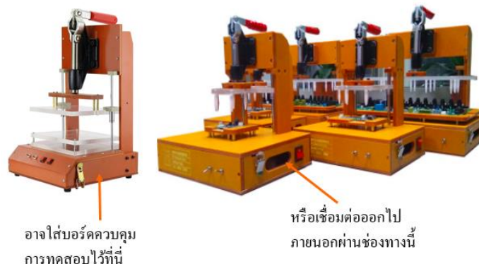
รูปที่ 4.47 FCT Test Fixture อย่างง่าย
