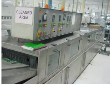
รูปที่ 4.26 เครื่องล้างบอร์ด
