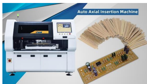
รูปที่ 4.33 Axial Insertion Machine สำหรับใส่อุปกรณ์ประเภท Axial
