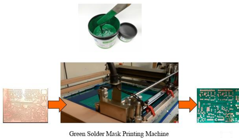
รูปที่ 3.17 พิมพ์ Green Solder Mask ลงบน PCB
