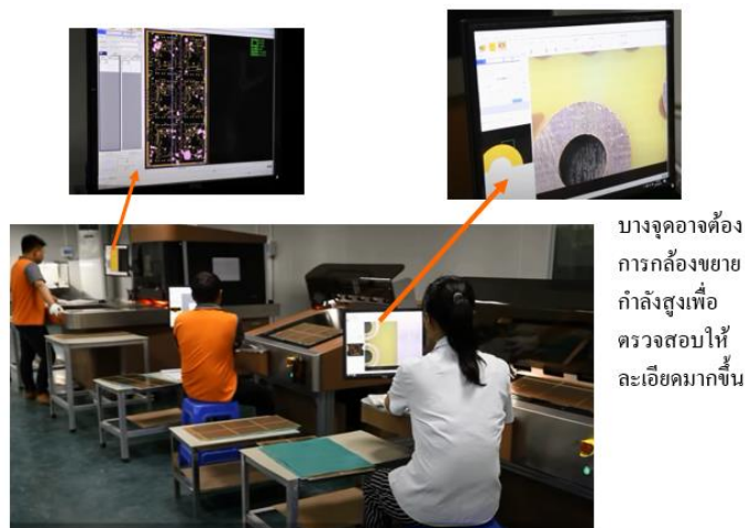
รูปที่ 3.16 การตรวจด้วย AOI และ ดูด้วยสายตาผ่านกล้องขยาย
