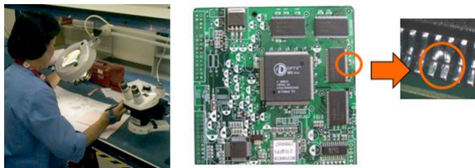
รูปที่ 4.24 Post Oven Inspection
