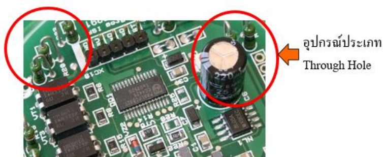
รูปที่ 4.31 ใส่อุปกรณ์ประเภท Through Hole หลังกระบวนการ SMT
