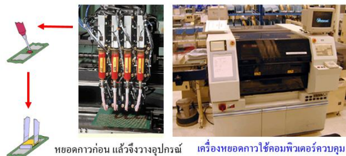
รูปที่ 4.18 การหยอดกาวเพื่อยึดอุปกรณ์
