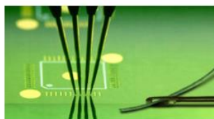
รูปที่ 3.23 หลักการของ Flying Probe
