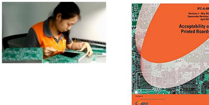
รูปที่ 3.27 การตรวจสอบขั้นสุดท้ายตามมาตรฐาน IPC-A-610
