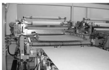
ตัดแผ่น Copper foil ให้เท่ากับแผ่น Prepreg ที่เตรียมไว้
