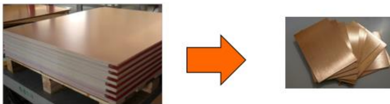
รูปที่ 3.3 นำ CCL มาตัดให้ได้ขนาดและทำความสะอาดพื้นผิว
