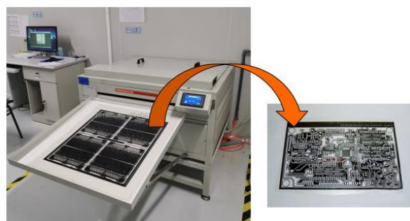
รูปที่ 3.9 การทำอาร์ตเวิร์กรูปลายเส้นบน PCB
