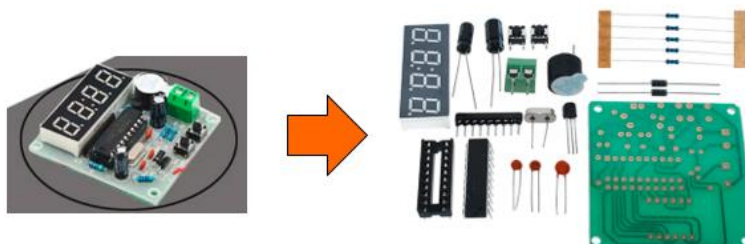
รูปที่ 1.7 BOM แสดงให้ทราบว่า ชิ้นงาน 1 ชิ้นประกอบไปด้วยอะไหล่บ้าง จำนวนเท่าใด
