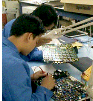
รูปที่ 4.50 การหาปัญหาที่ทำให้เกิดความบกพร่องและแก้ไขให้กลับมาทำงานอย่างถูกต้อง
