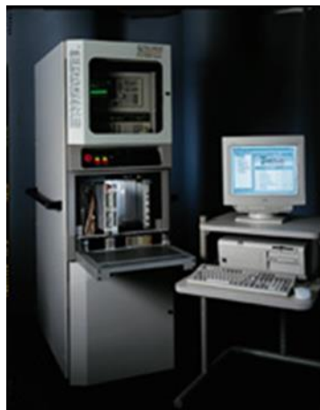
รูปที่ 4.49 ระบบทดสอบแบบอัตโนมัติที่มีความซับซ้อนมากขึ้นและติดตั้งบน Rack
