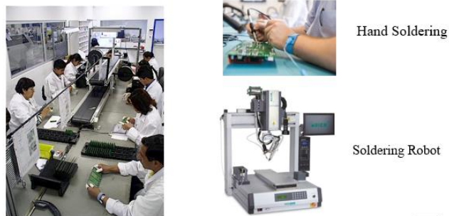
รูปที่ 4.39 Second Manual Insertion หรือ Second Hand-load
